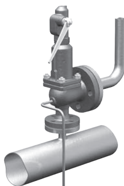
Правильная установка на паропровод
