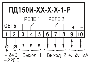
Рисунок 1 – Назначение контактов клеммника
